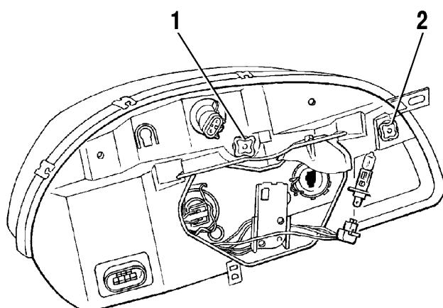
Поставьте полностью заправленный и снаряженный автомобиль, с нагрузкой 735 Н (75 кгс) на сиденье водителя, на ровной горизонтальной площадке в 5 м от экрана (щит фанеры размером около 2x1 м и т.п.) так, чтобы ось автомобиля была ему перпендикулярна. Перед разметкой экрана удостоверьтесь, что давление воздуха в шинах нормальное, а затем качните автомобиль сбоку, чтобы установились пружины подвесок.
