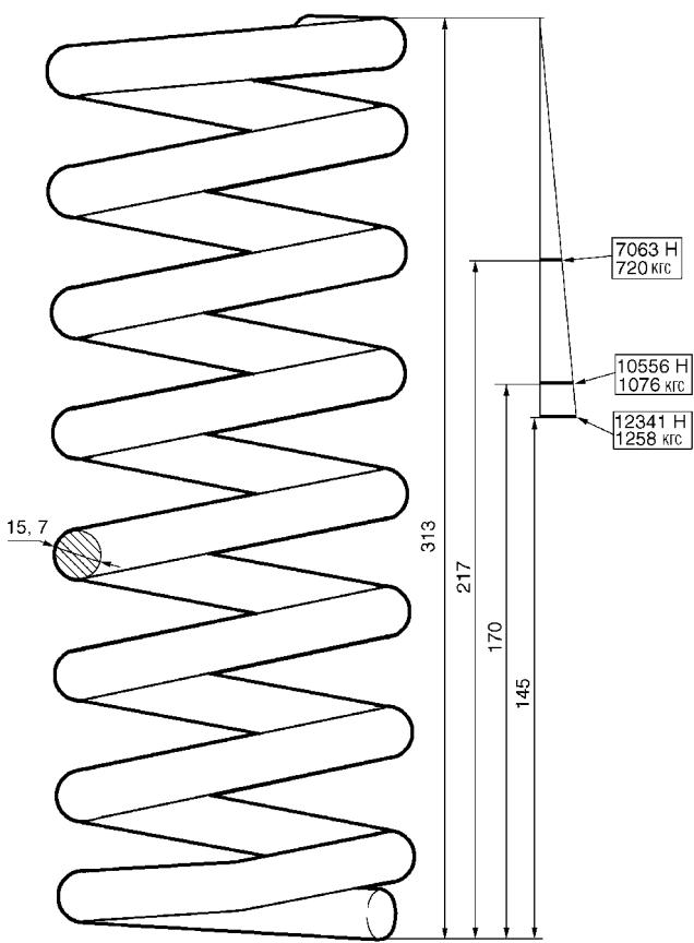
Рис. 4-7. Основные данные для проверки пружины передней подвески.
