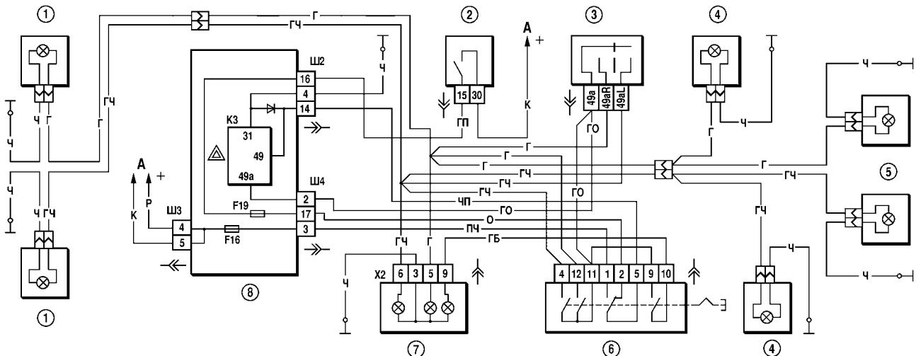
Рис. 7-21. Схема включения указателей поворота и аварийной сигнализации:
