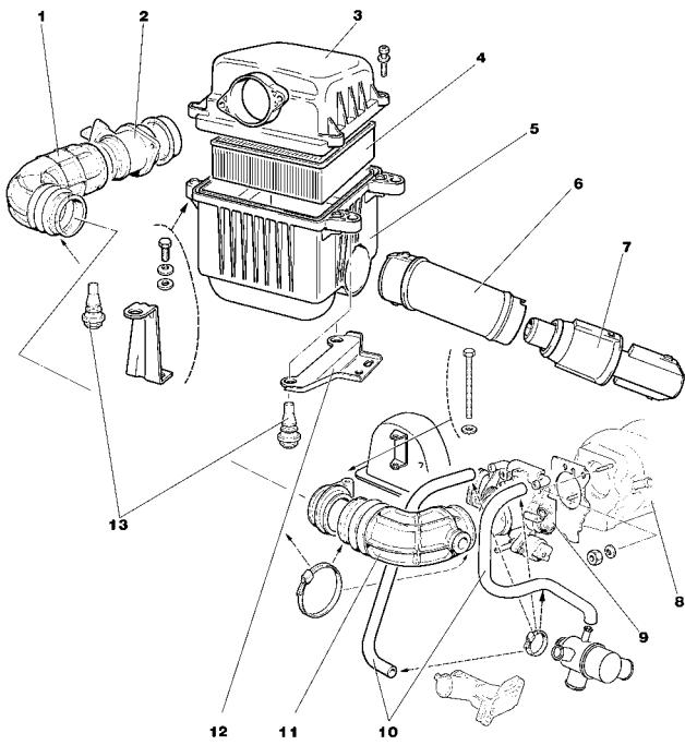
Ослабьте два стяжных хомута и снимите шланг 1 (рис. 2-5) впускной трубы, отсоединив его от патрубка и шланга вентиляции картера двигателя.
