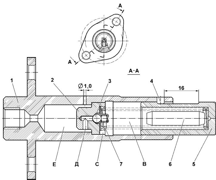
Рис. 2-46. Гидравлический натяжитель цепи:
