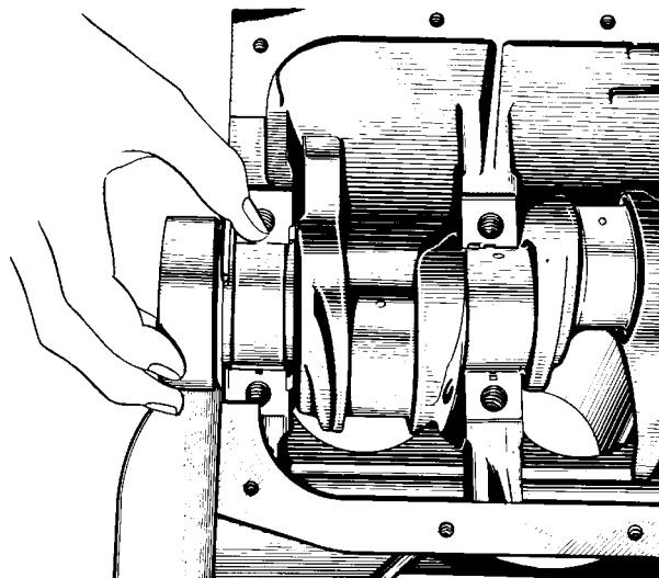
Рис. 2-16. Установка упорных полуколец на задней опоре
