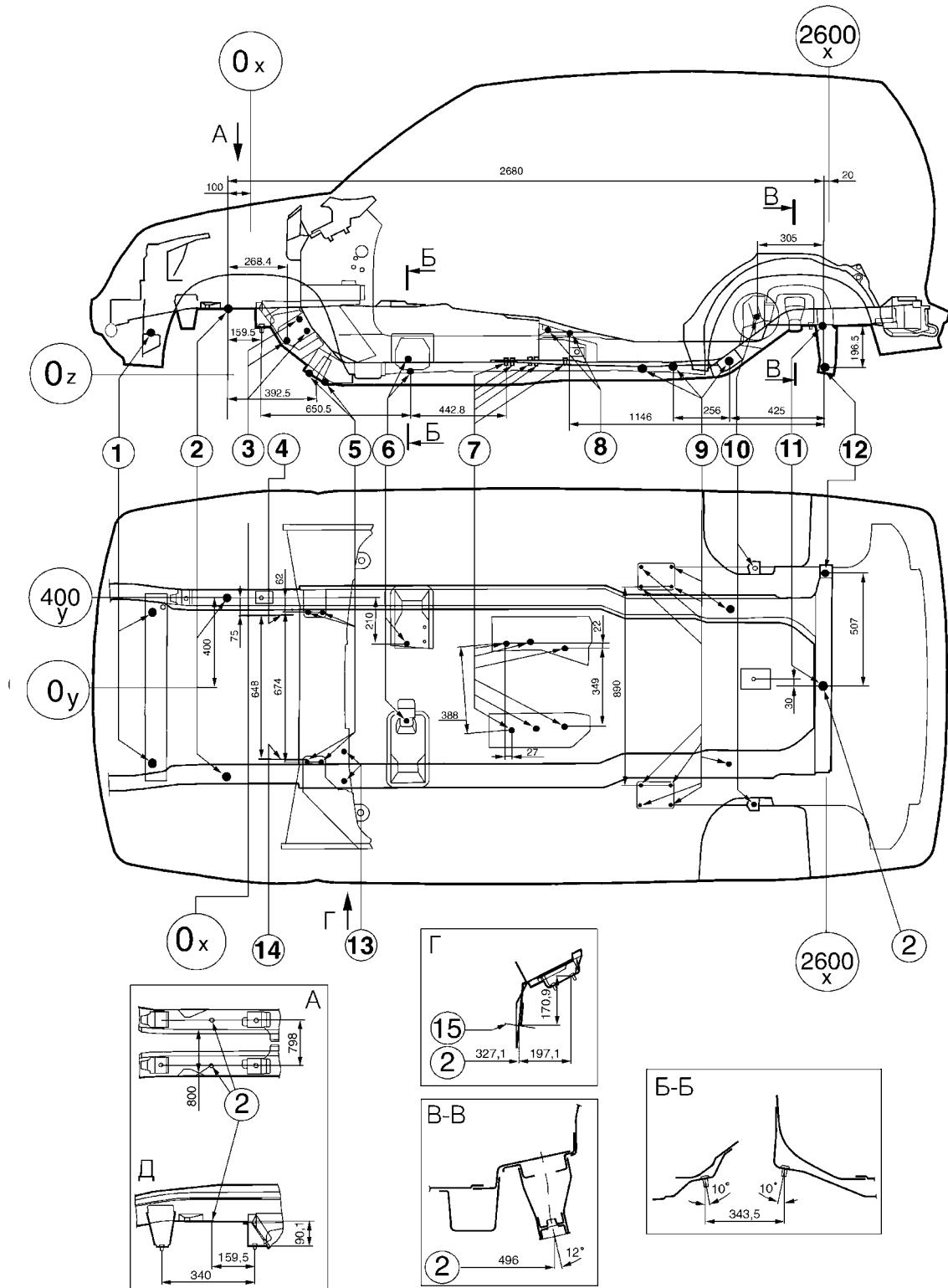
*Рис. 8-5. Основные справочные размеры точек крепления узлов и агрегатов автомобиля:*
