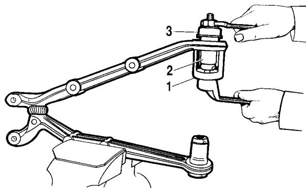
Рис. 4-11. Запрессовка шарниров нижнего рычага:
