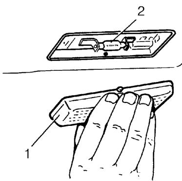
**Плафон освещения салона.** В плафоне освещения салона (рис. 7-26) перегоревшую лампу 2 менять, сняв рассеиватель 1, для чего нажмите пальцами на рассеиватель с боков по оси его включения/выключения и потяните его вниз. Лампа удерживается в плафоне пружинными контактами.
