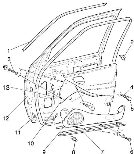
Рис. 8-10. Снятие обивки передней двери:
