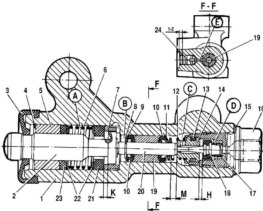
Рис. 6-22. Регулятор давления задних тормозов в нерабочем положении:
