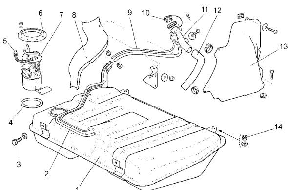
Рис. 2-76. Снятие топливного бака:
