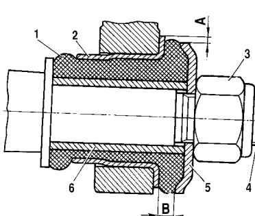
*Рис. 4-3. Проверка зазора в верхних шаровых шарнирах подвески на автомобиле:*
