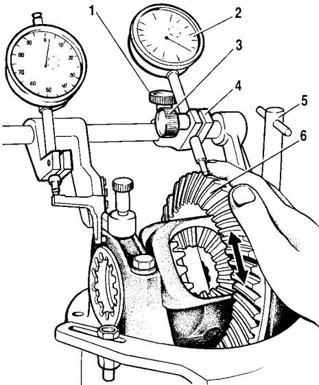
Рис. 3-75. Проверка бокового зазора в зацеплении шестерен главной передачи приспособлением A.95688/R:
