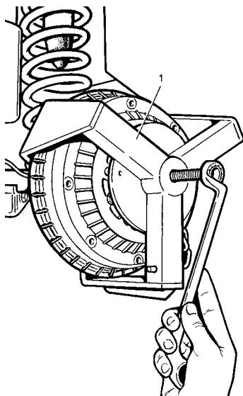
Рис. 6-17. Снятие тормозного барабана:
