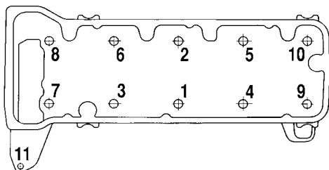
Рис. 2-22. Порядок затягивания болтов головки цилиндров
