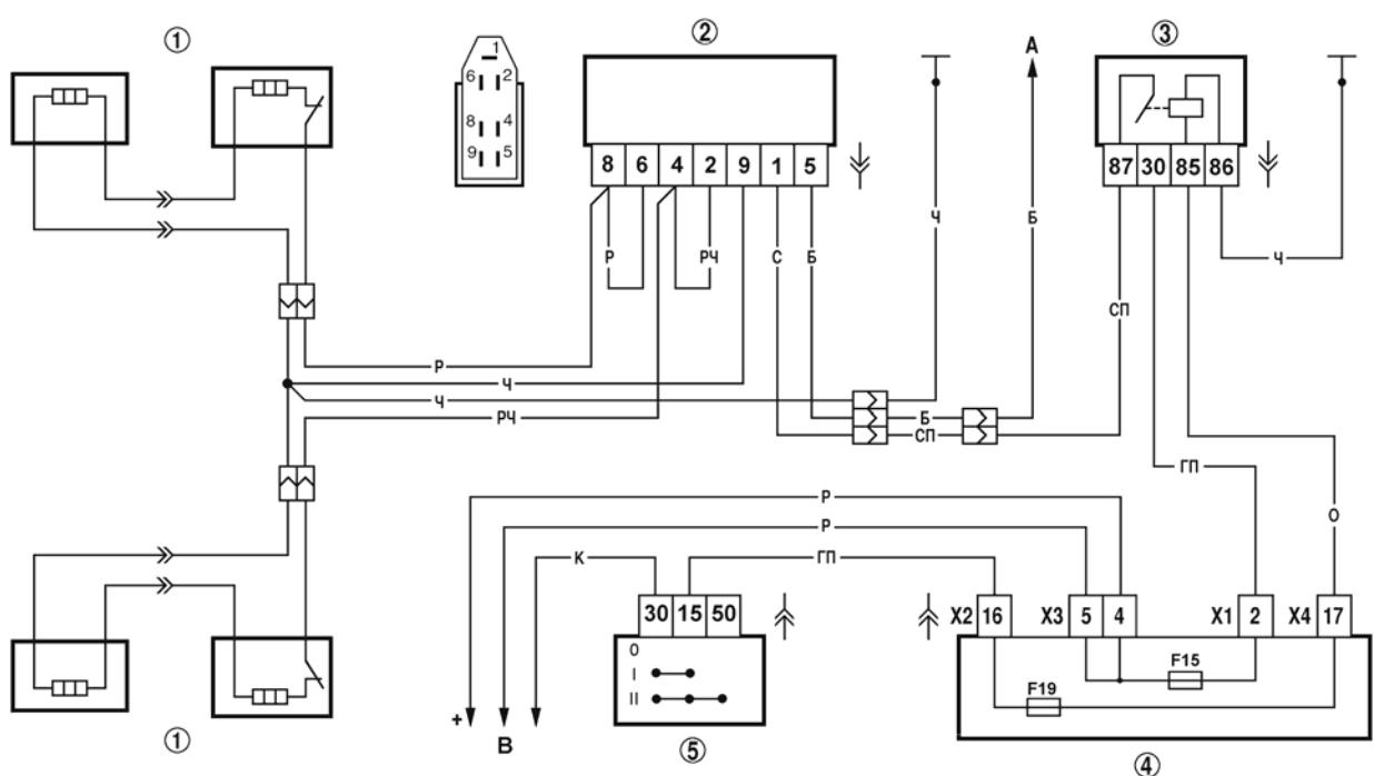
Рис. 7-37. Схема включения обогрева передних сидений
