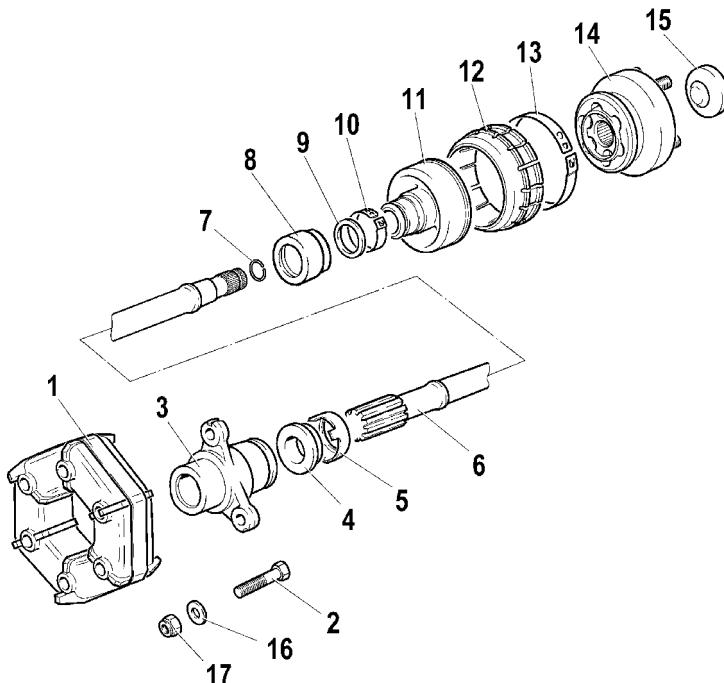
Рис. 3-45. Детали промежуточного карданныго вала:
