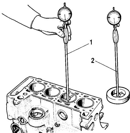
Рис. 2-31. Измерение цилиндров нутрометром:
