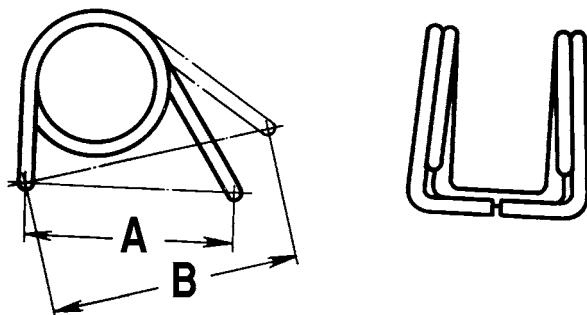
Рис. 2-56. Схема проверки пружины рычага:
