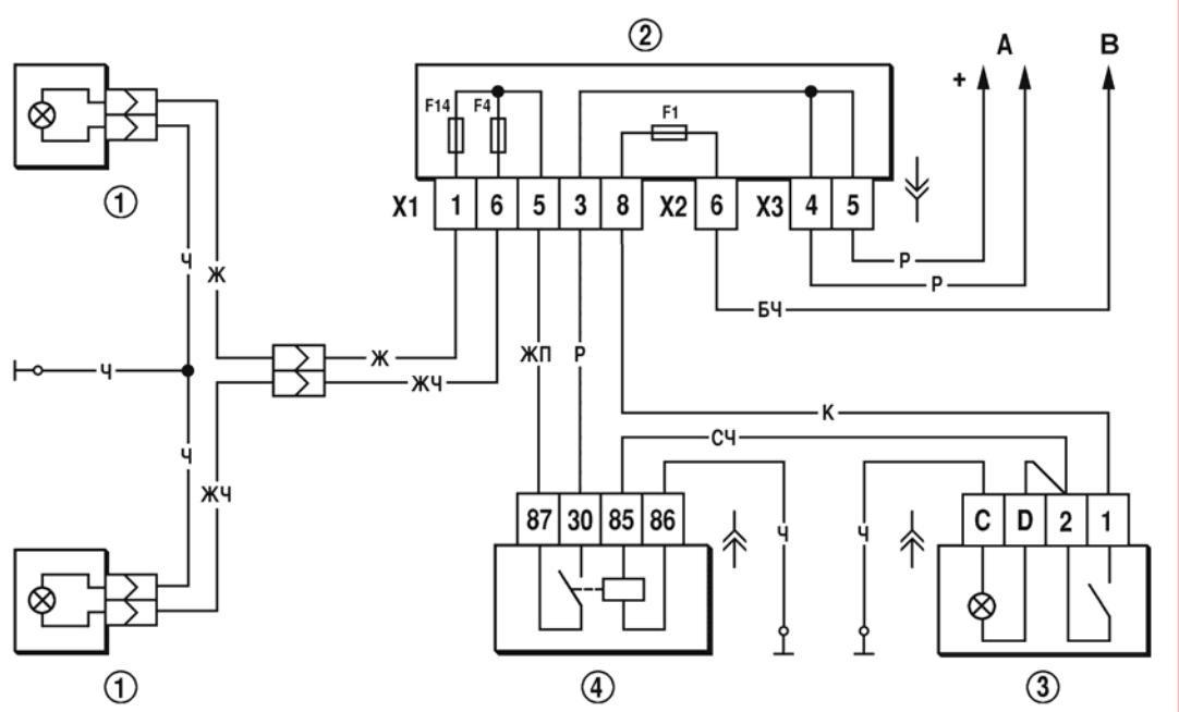
Рис. 7-39. Схема включения противотуманных фар
