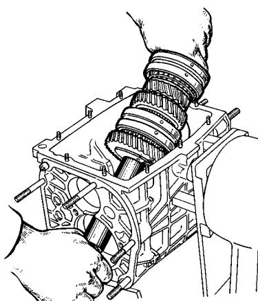
Рис. 3-24. Извлечение вторичного вала из картера коробки передач
