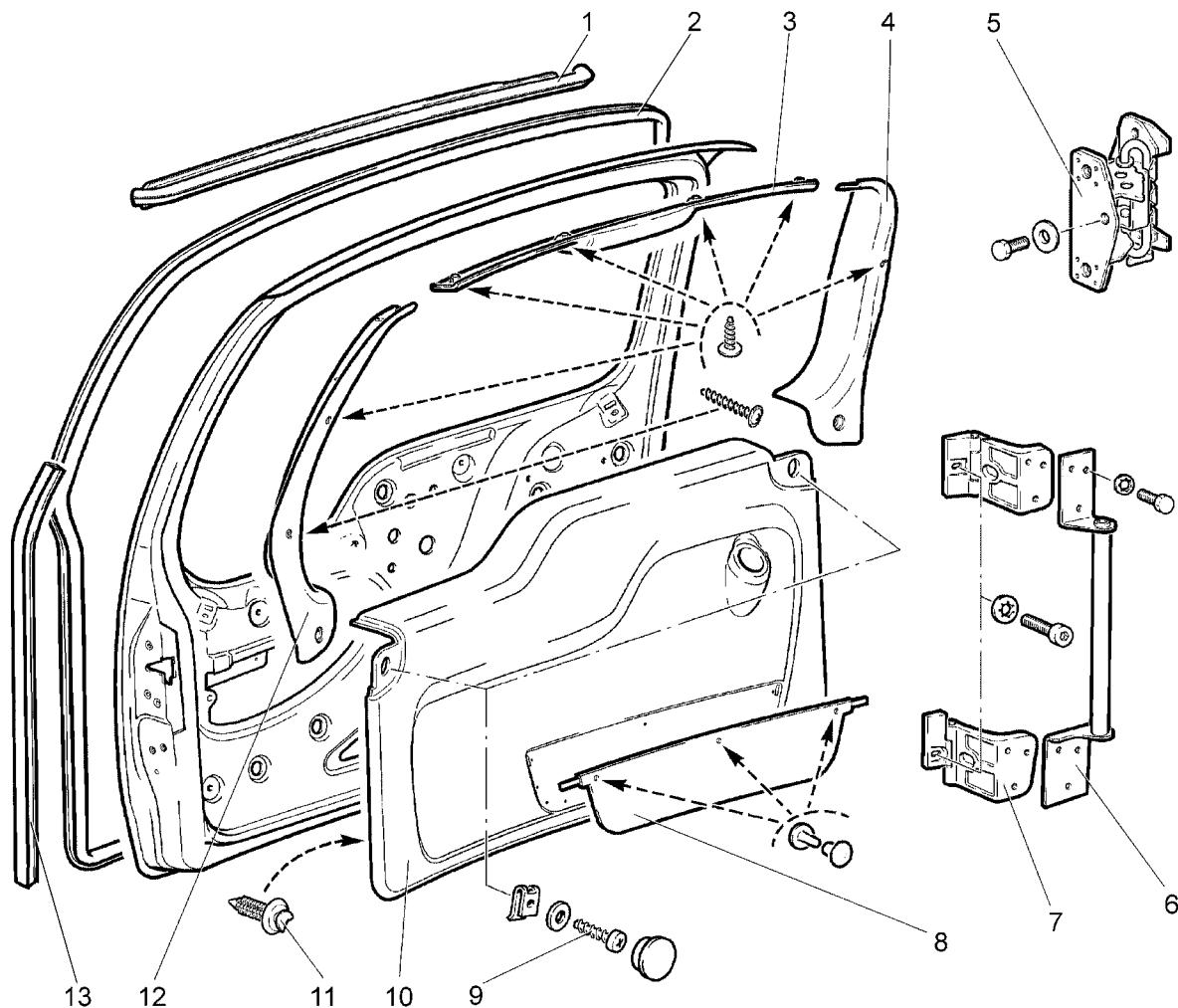
Рис. 8-17. Снятие обивок двери задка:
