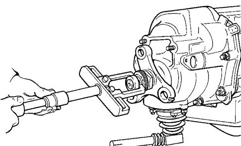
Рис. 3-14. Снятие центрирующего кольца эластичной муфты карданного вала
