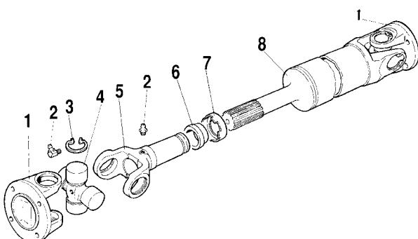
Рис. 3-46. Детали переднего карданныго вала:
