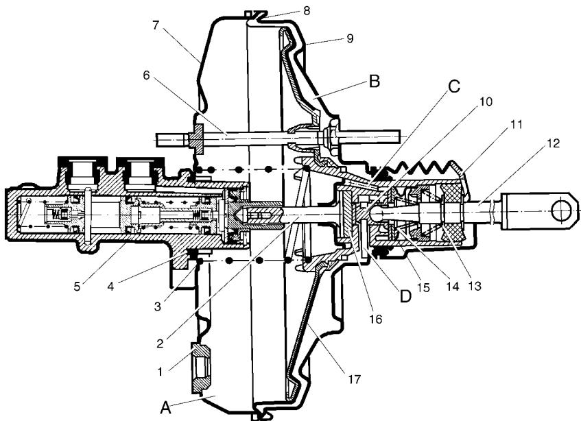
*Рис. 6-2. Вакуумный усилитель:*
