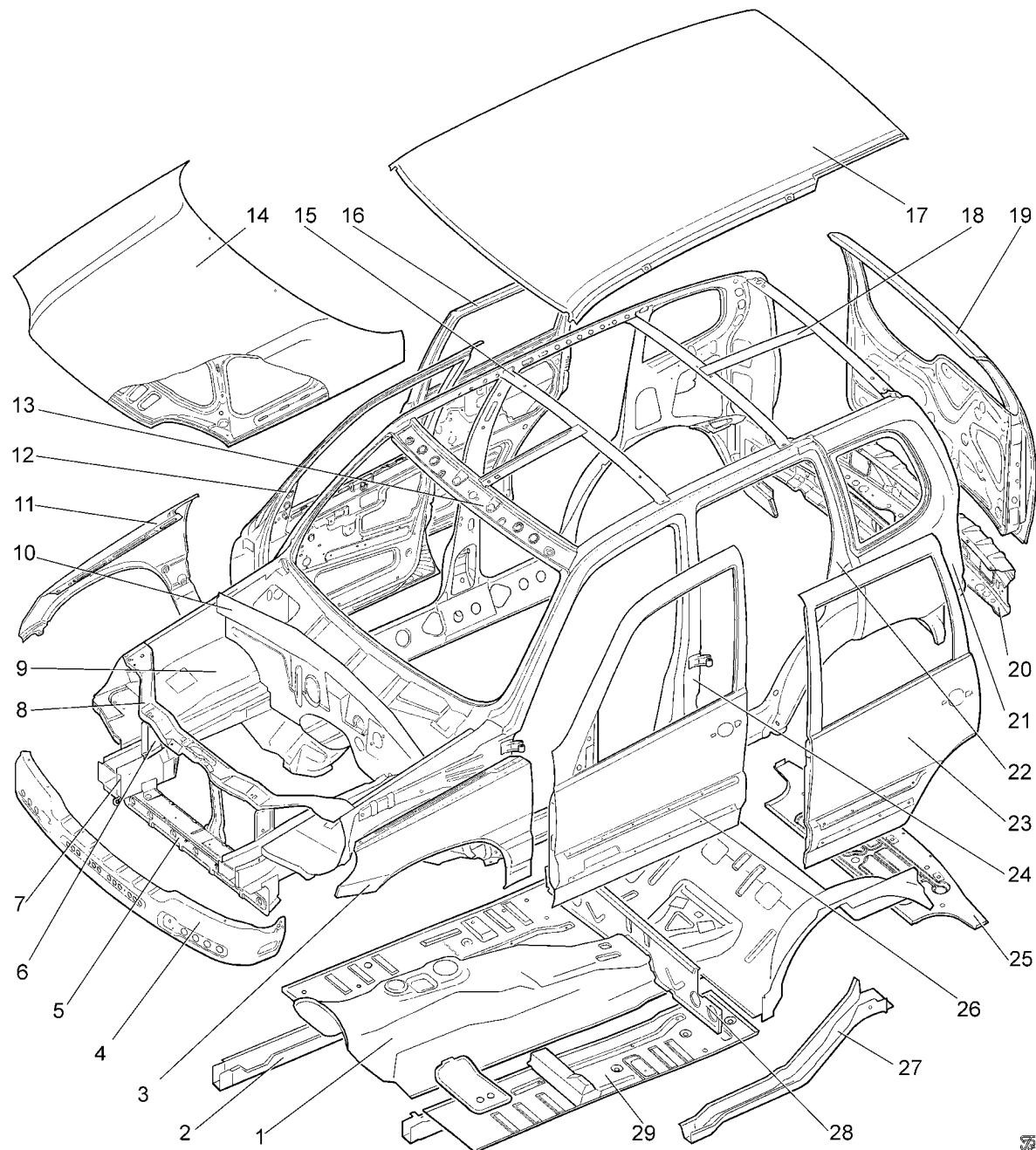
Рис. 8-1. Детали каркаса кузова:
