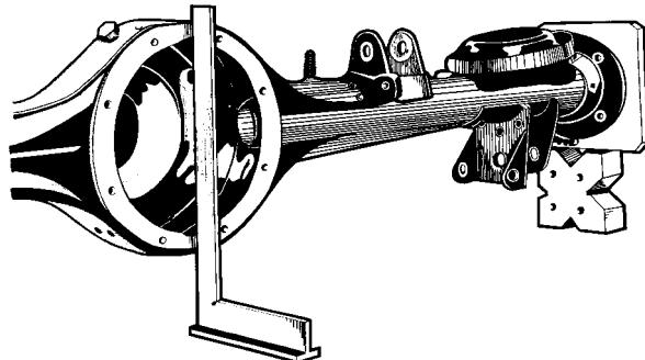
Рис. 3-55. Проверка перпендикулярности поверхности крепления редуктора.
