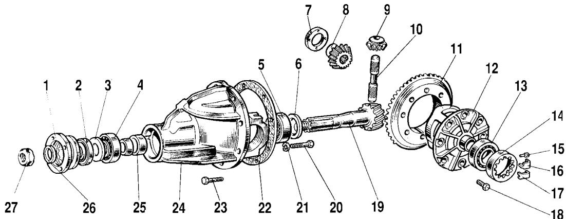
Рис. 3-66. Детали редуктора заднего моста:
