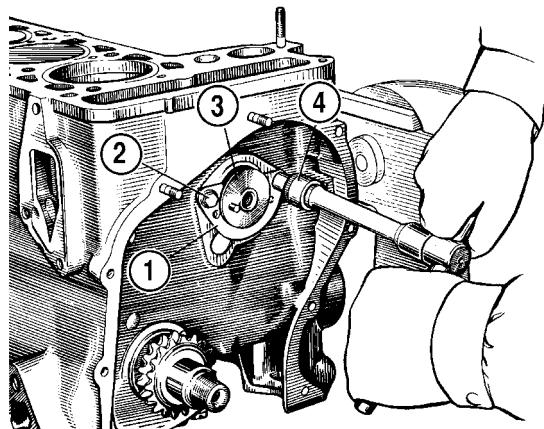
Универсальным съемником А.40005/1/7 из комплекта А.40005 снимите звездочку с коленчатого вала (рис. 2-14).
