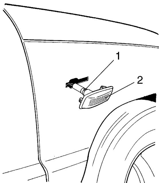
**Боковой указатель поворотов.** Для замены лампы в боковом указателе поворотов (рис. 7-28) снимите его с автомобиля. В гнезде указатель удерживается пружинными фиксаторами. Затем снимите защитный резиновый колпачок 1, выньте патрон в сборе с лампой из корпуса 2 и извлеките лампу.
