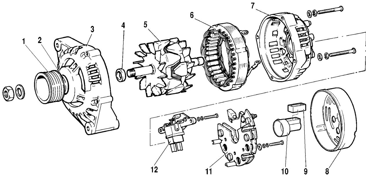
Рис. 7-13. Детали генератора:
