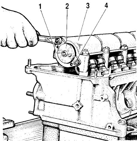
Рис. 2-12. Снятие упорного фланца распределительного вала:
