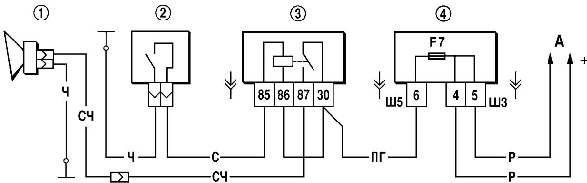
Рис. 7-31. Схема включения звукового сигнала:
