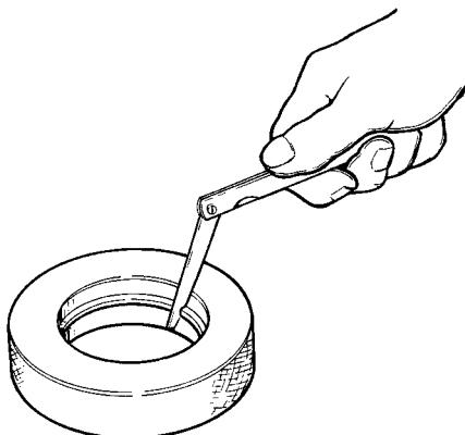
Рис. 2-38. Проверка зазора между поршневыми кольцами и канавкам
