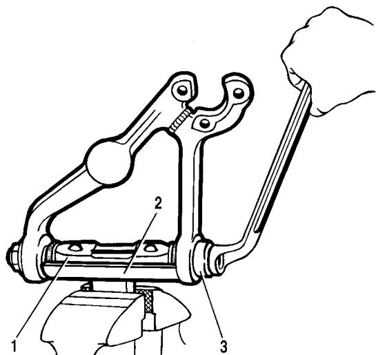
Рис. 4-9. Запрессовка шарниров верхнего рычага:
