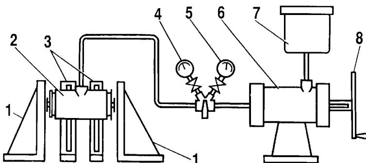
Рис. 6-20. Схема проверки колесных цилиндров задних тормозов:
