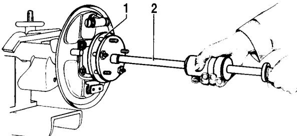
*Рис. 3-52. Выпрессовка полуоси:*
