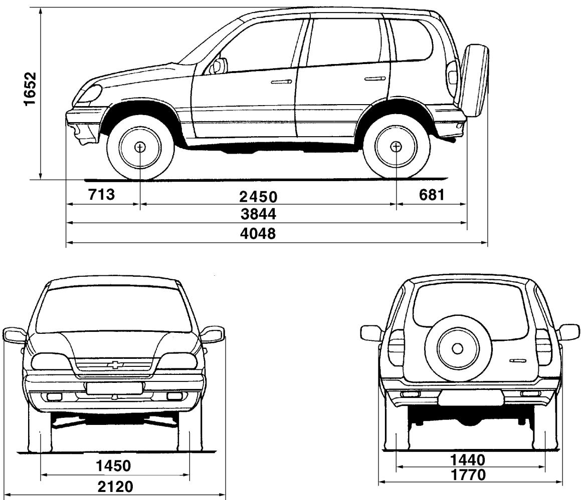
Рис. 1-1. Основные габаритные размеры (справочные) автомобиля Шевроле-Нива
