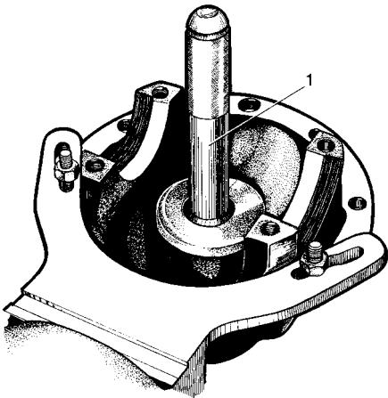
Рис. 3-67. Установка наружного кольца заднего подшипника ведущей шестерни оправкой:
