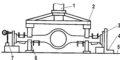
Рис. 3-57. Схема правки балки заднего моста:
