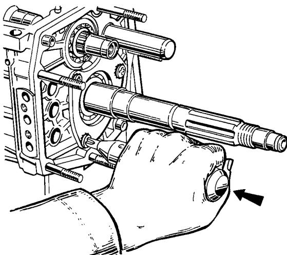
Рис. 3-22. Отвертывание винтов крепления стопорной пластины промежуточного подшипника вторичного вала дрелью-отверткой.
