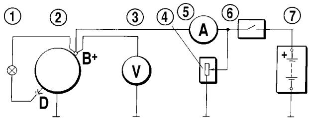
Рис. 7-7. Схема соединений для проверки генератора на стенде:
