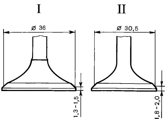
Рис. 2-53. Предельные размеры при шлифовании фасок клапанов:
