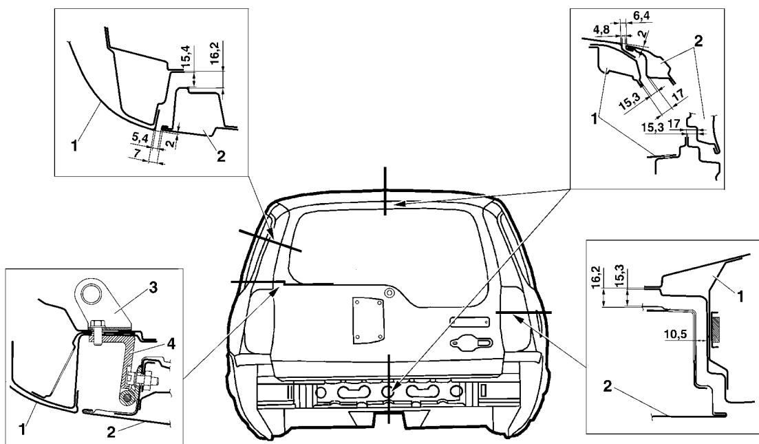
Рис. 8-4. Скрытые полости кузова (вид сзади):
