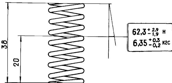
Рис. 2-72. Основные данные для проверки пружины редукционного клапана
