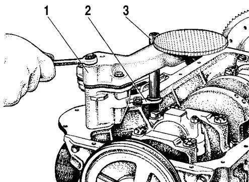
*Рис. 2-28. Установка масляного насоса:*
