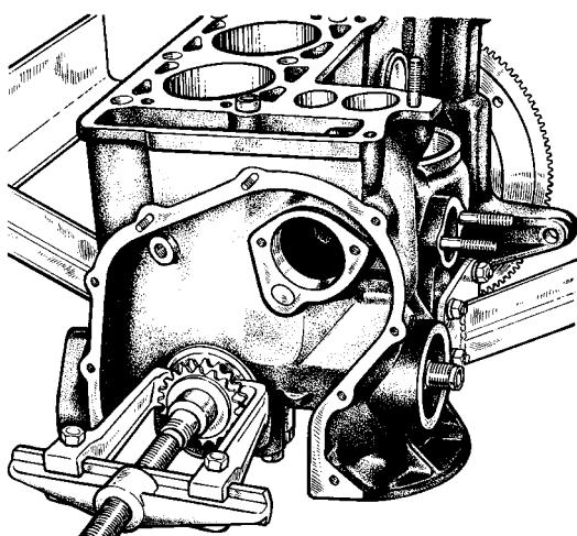
Рис. 2-14. Снятие звездочки коленчатого вала универсальным съемником
