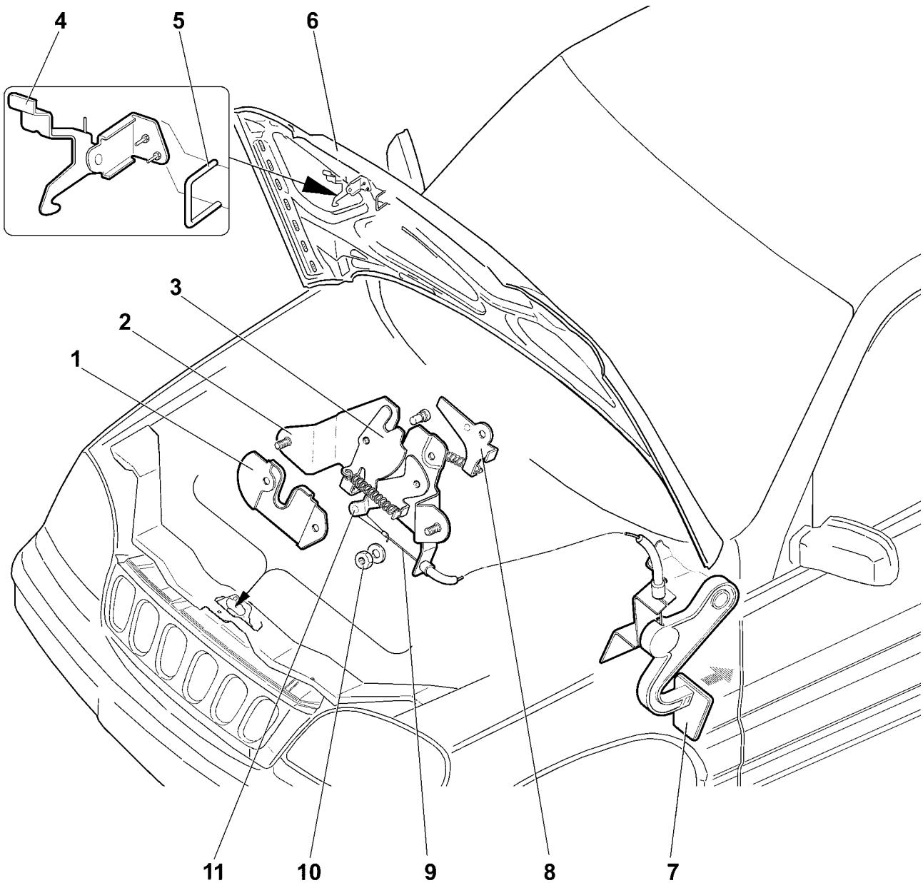
Рис. 8-8. Замок капота:
