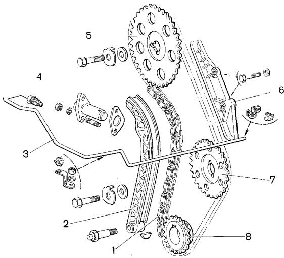
Рис. 2-11. Элементы механизма натяжения цепи:
