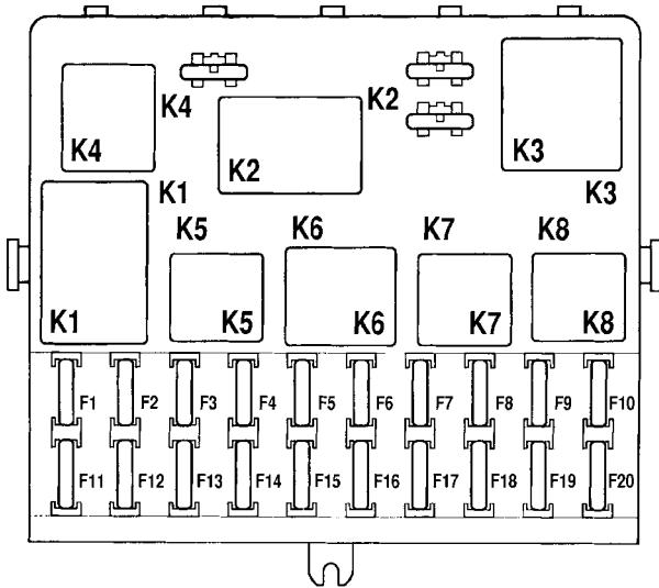
Рис. 7-2. Расположение реле и предохранителей в монтажном блоке:
