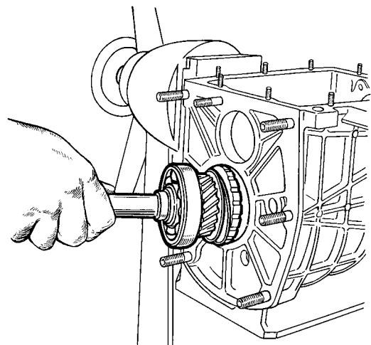
Рис. 3-23. Извлечение первичного вала из картера коробки передач
