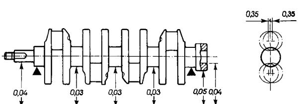
Рис. 2-41. Допустимые биения основных поверхностей коленчатого вала
