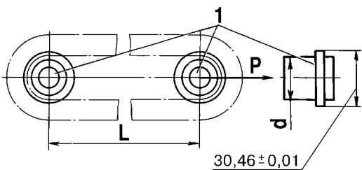
Рис. 2-59. Схема проверки износа (вытяжки) цепи:
