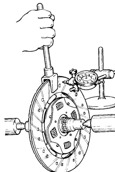
Рис. 3-6. Проверка биения и правка ведомого диска сцепления
