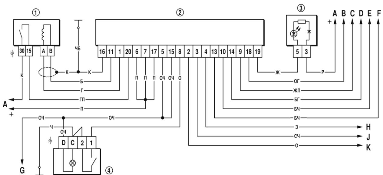
Рис. 7-42. Схема соединений автомобильной противоугонной системой
