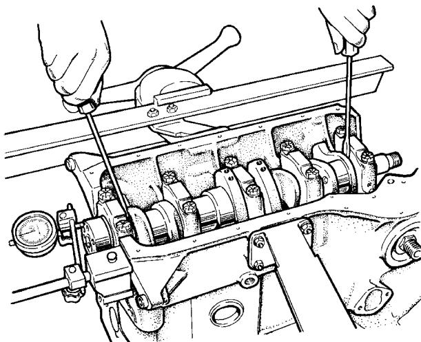
Рис. 2-18. Проверка осевого свободного хода коленчатого вала
