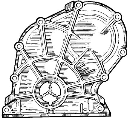
*Рис. 2-27. Крышка привода распределительного вала.
