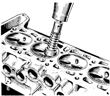
Рис. 2-51. Шлифование рабочей фаски седла клапана
