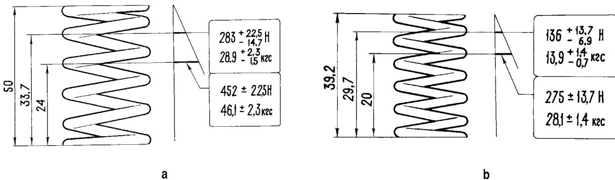
Рис. 2-55. Основные данные для проверки наружной (a) и внутренней (b) пружины клапана
