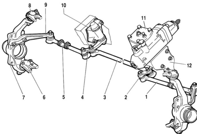
*Рис. 5-1. Рулевой механизм в сборе с приводом:*
