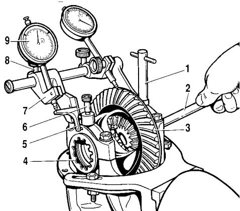
Рис. 3-74. Проверка предварительного натяга подшипников коробки дифференциала приспособлением A.95688/R:
