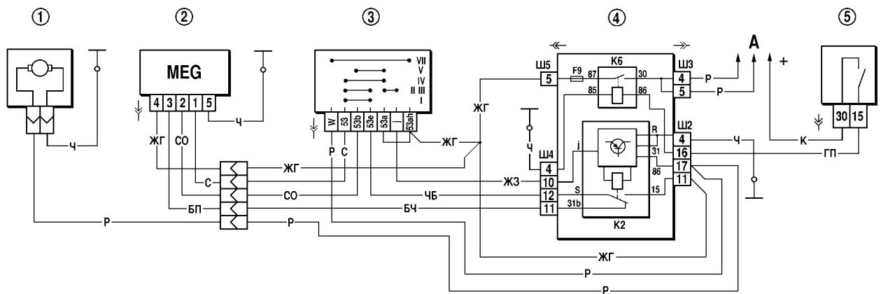
Рис. 7-32. Схема включения очистителя и омывателя ветрового стекла:
