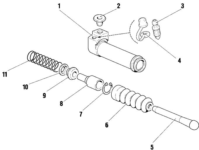
Рис. 3-9. Детали цилиндра привода выключения сцепления (рабочего цилиндра):
