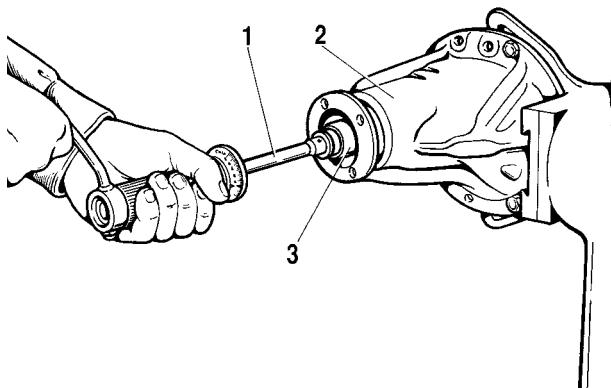
Рис. 3-73. Проверка предварительного натяга подшипников ведущей шестерни:
