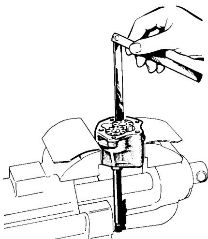
Рис. 2-70. Проверка радиального зазора в масляном насосе
