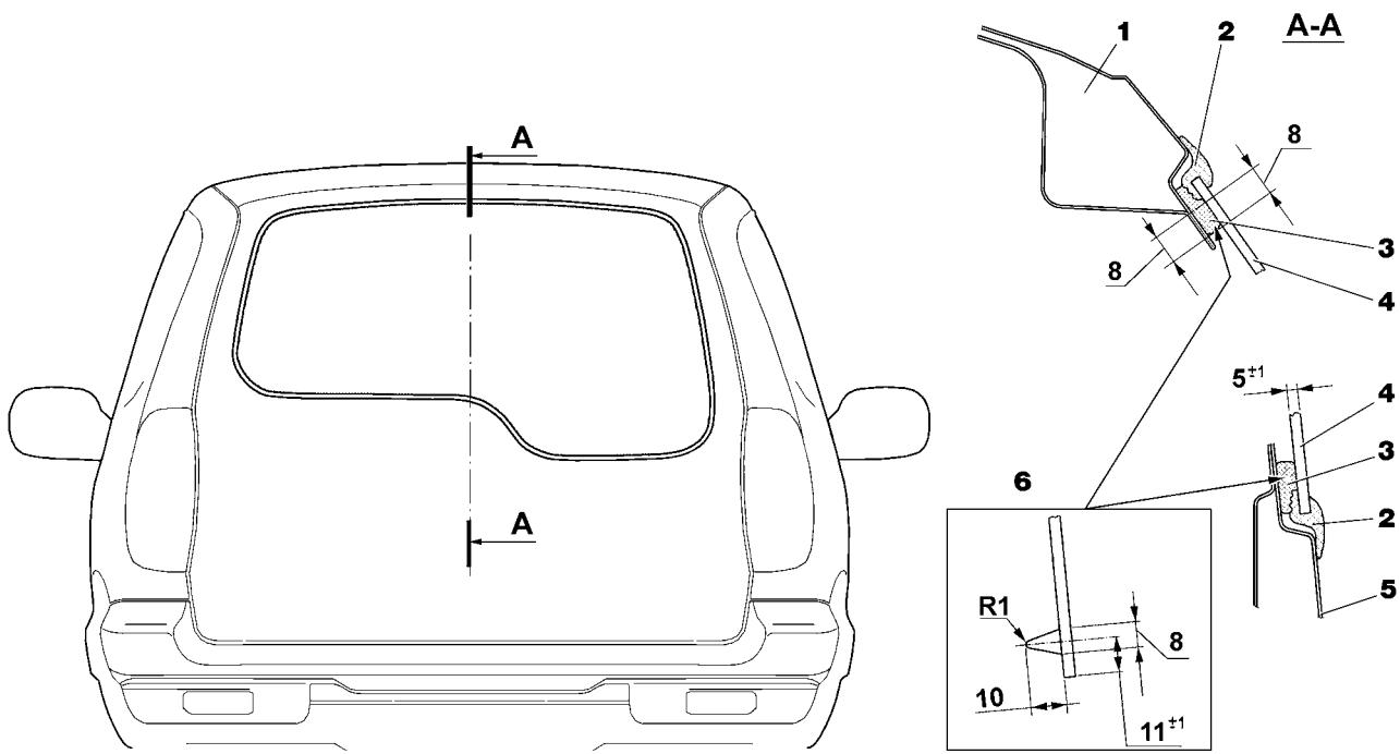
Рис. 8-28. Снятие и установка стекла задка:
