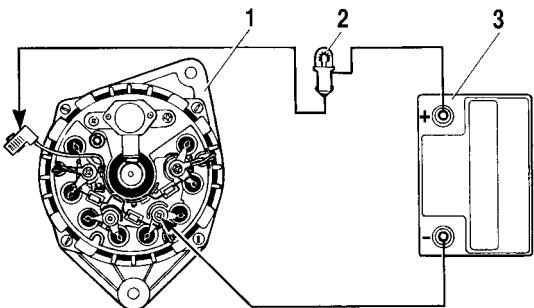
*Рис. 7-11. Схема для проверки дополнительных диодов:*
