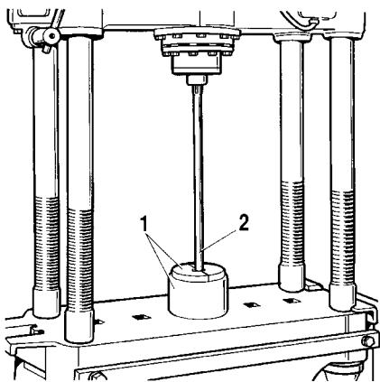
*Рис. 3-58. Выпрессовка запорного кольца подшипника полуоси:*
