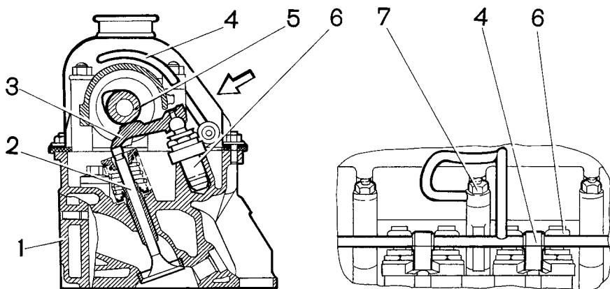
Рис. 2-45. Механизм привода клапанов:
