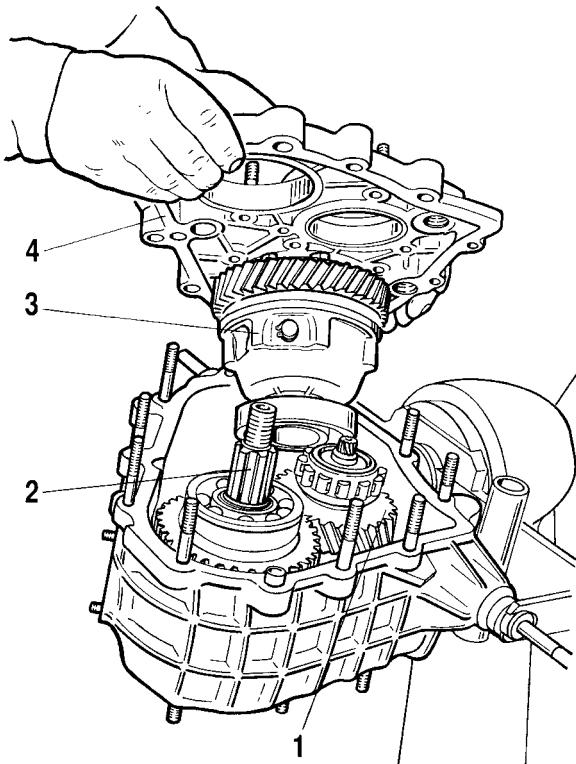
*Рис. 3-36. Снятие передней крышки раздаточной коробки:*
