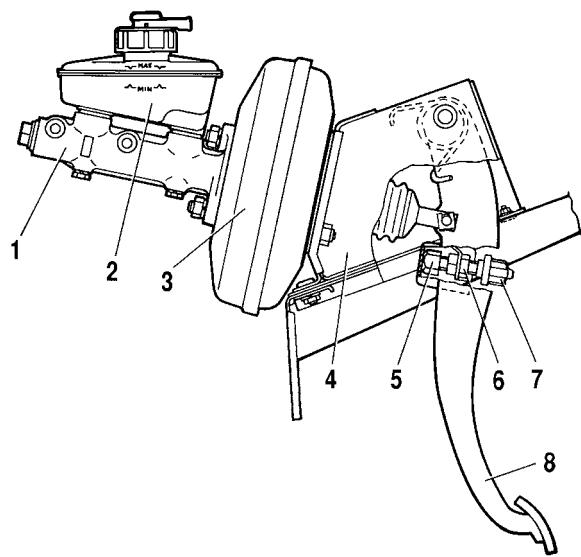
*Рис. 6-3. Привод тормозов:*
