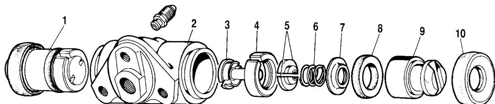
Рис. 6-19. Детали колесного цилиндра:
