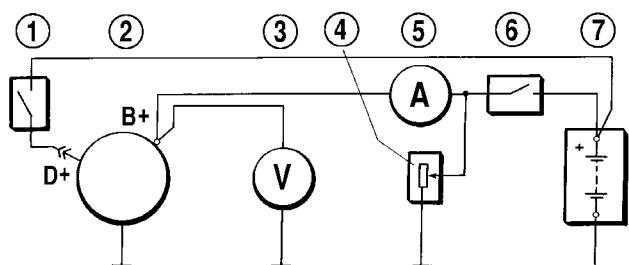
Рис. 7-8. Схема соединений для проверки генератора осциллографом:
