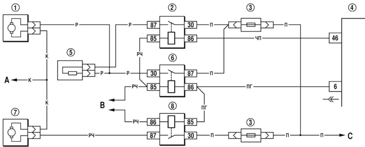
Рис. 7-40. Схема включения электродвигателей вентиляторов системы охлаждения
