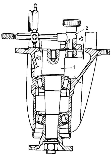
Рис. 3-69. Схема снятия замеров для определения толщины регулировочного кольца ведущей шестерни:
