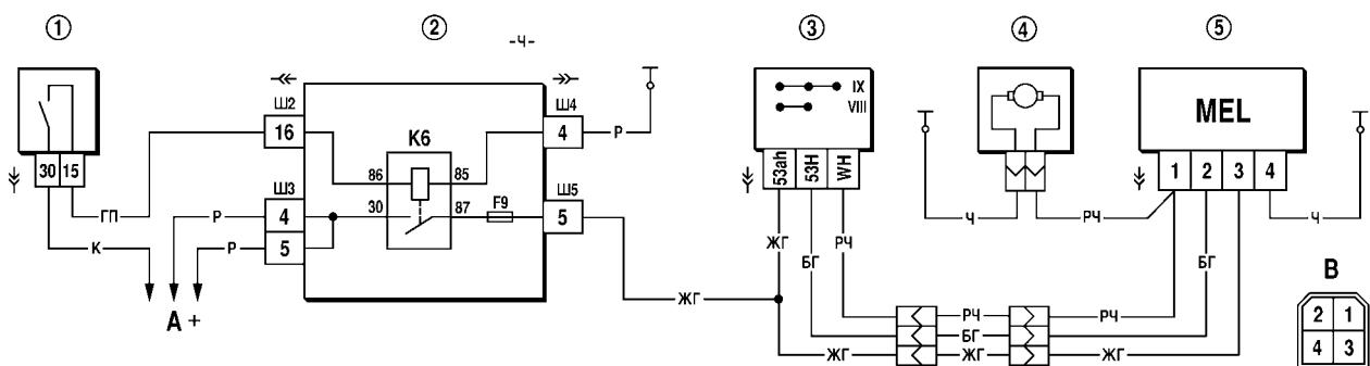
Рис. 7-33. Схема включения очистителя и омывателя заднего стекла:
