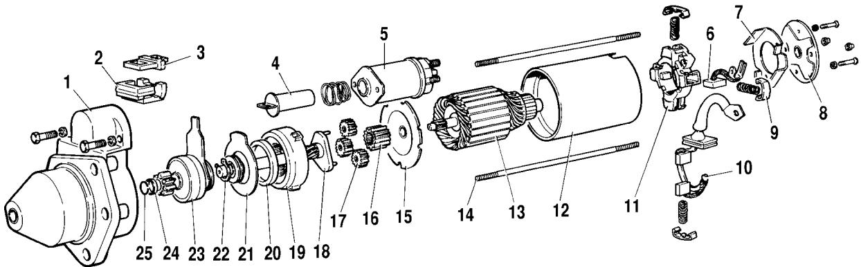
Рис. 7-17. Детали стартера:
