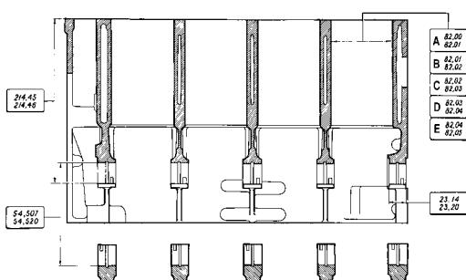
Рис. 2-29. Основные размеры блока цилиндров
