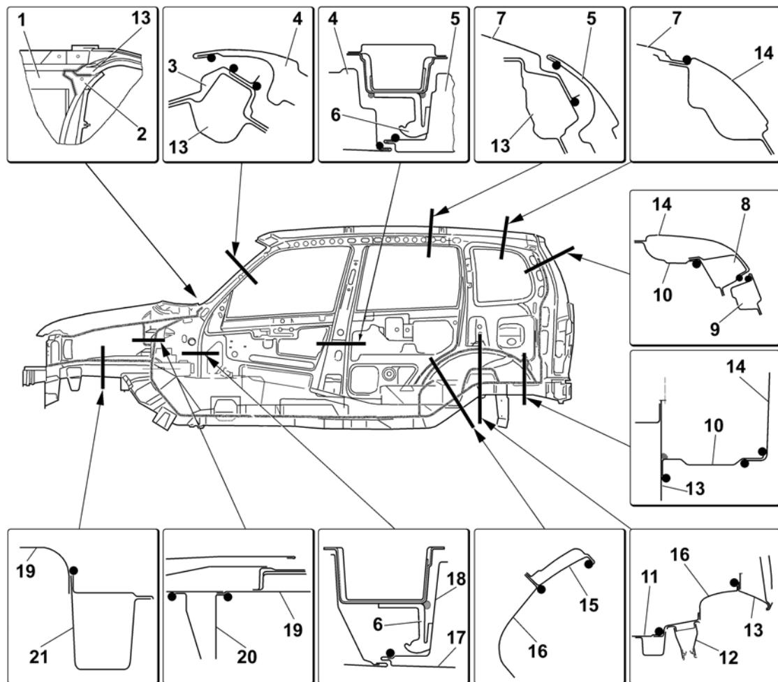
Рис. 8-6. Места нанесения уплотнительной мастики (вид сбоку):
