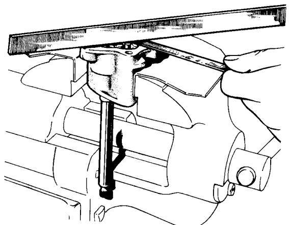
Рис. 2-71. Проверка осевого зазора в масляном насосе
