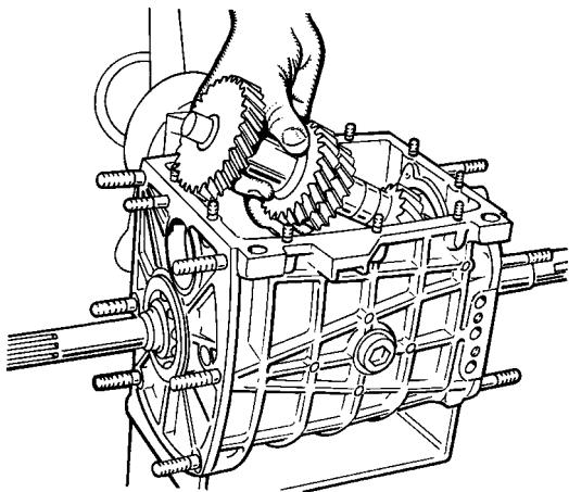
Рис. 3-20. Извлечение промежуточного вала из картера коробки передач
