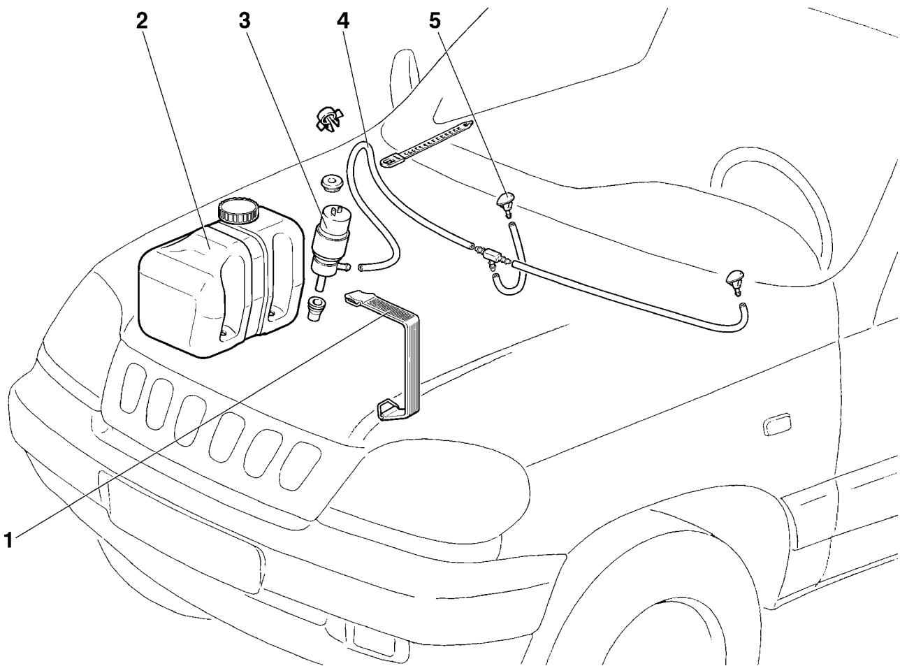
Рис. 8-24. Схема омывателей ветрового стекла:
