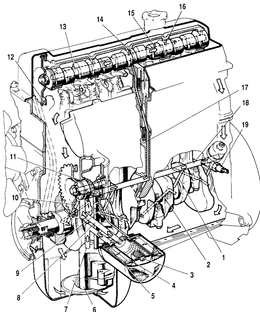
Рис. 2-67. Система смазки:
