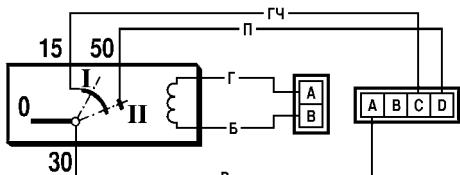
Рис. 7-4. Схема соединений выключателя зажигания (при вставленном ключе).
