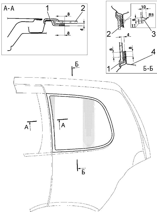
Рис. 8-27. Снятие и установка стекла боковины:
