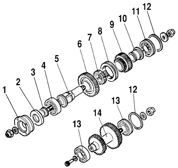
*Рис. 3-37. Детали ведущего и промежуточного валов:*
