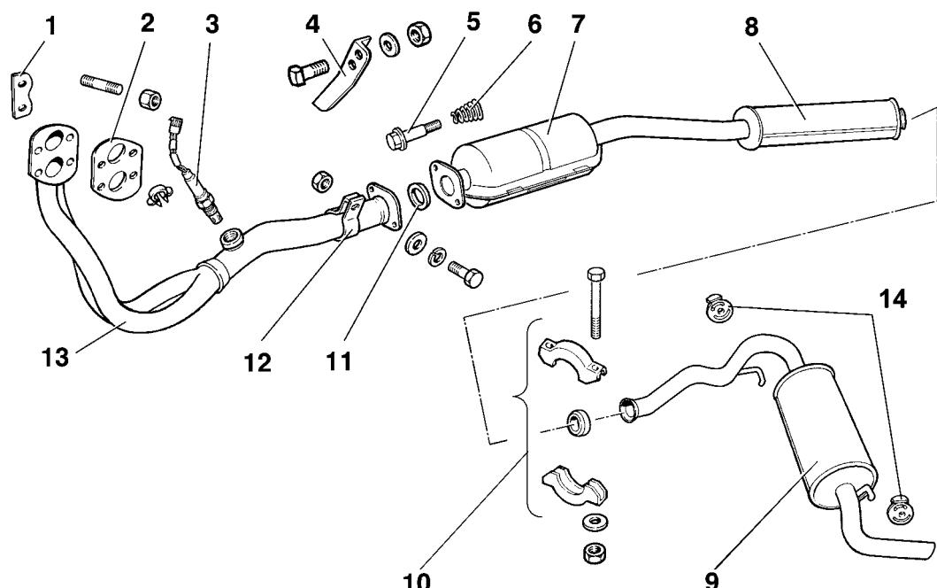
Рис. 2-77. Система выпуска отработавших газов:
