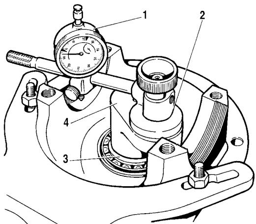
Рис. 3-68. Определение толщины регулировочного кольца ведущей шестерни:
