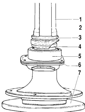
*Рис. 3-59. Запрессовка запорного кольца подшипника полуоси:*
