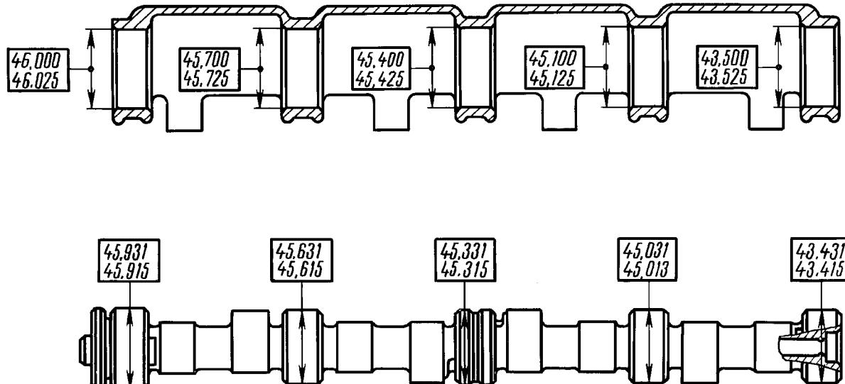
Рис. 2-57. Основные размеры распределительного вала и корпуса подшипников
