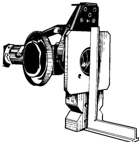
Рис. 3-56. Проверка горизонтальных деформаций балки заднего моста угольником по наружной поверхности фланца А.70172.
