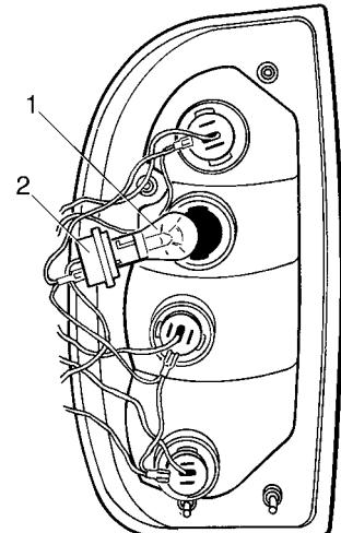
**Задний фонарь.** Замену ламп в заднем фонаре проводите со стороны багажного отделения, предварительно открыв клапан в обивке боковины багажного отделения. Для доступа к перегоревшей лампе 1 (рис. 7-25) поверните патрон 2 против часовой стрелки и выньте его в сборе с лампой. Чтобы вынуть лампу из патрона нажмите на лампу и поверните ее против часовой стрелки.
