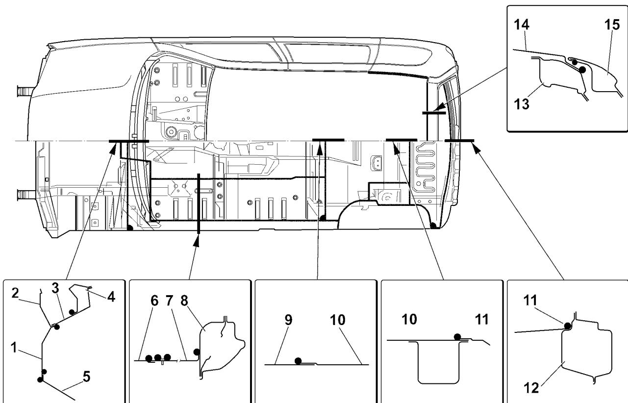
Рис. 8-7. Места нанесения уплотнительной мастики (вид сверху):
