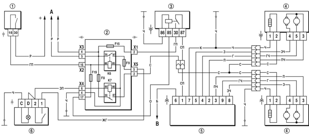
Рис. 7-38. Схема включения электроуправляемых зеркал
