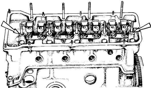
Рис. 2-24. Установочные втулки для корпуса подшипников распределительного вала
