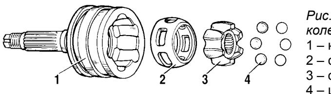
*Рис. 3-80. Детали наружного шарнира привода передних колес:*
